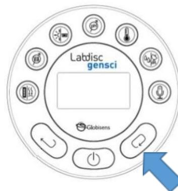
**NOTA:** Si bien la configuración anterior, nos guía para la toma de muestras en conexión directa con una computadora, el dispositivo Labdisc posee un visor, una memoria y una batería, que posibilitan, además, la recolección de datos en forma independiente, sin tener que estar conectado a otro equipo. Más detalles en [nuestro canal de YouTube](#)
